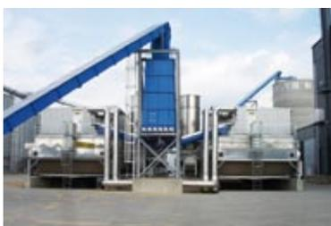
Bei Pellet- und Brikettproduktionsanlagen werden inhomogene biologische Einsatzmaterialien in einen definierten Brennstoff konvertiert. Einer der Vorteile dieses Brennstoffes ist seine Tauglichkeit für konventionelle Feuerungsanlagen.
